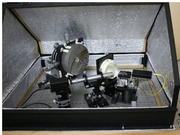
Рис.1 Фотография интерферометра, с компенсатором волнового фронта для измерения формы асферических вогнутых поверхностей.
