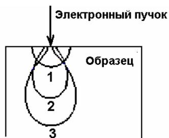
Рис.2 Зависимость формы области торможения электронов в зависимости от их энергии 1) энергия электронов 1кэВ, 2) 2,5 кэВ, 3) 5 кэВ [3]
