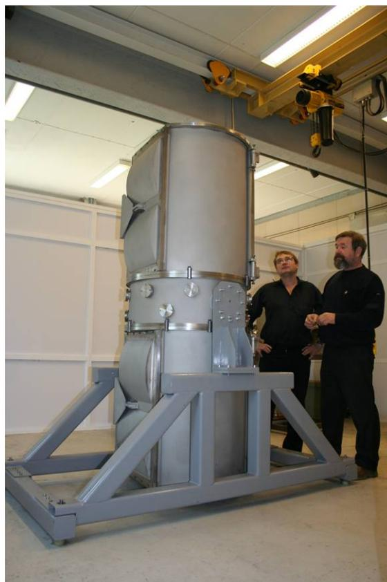
Рис.5 Фотография вертикального вакуумного интерферометра.
