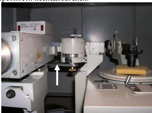
Рис. 2. Фотография дифрактометра ДРОН-3. Стрелкой указана штанга крепления корпуса монокроматора, в котором установлено ПМРЗ к трубке.
