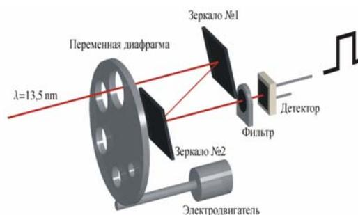
Рис.2. Оптическая схема измерителя мощности.
