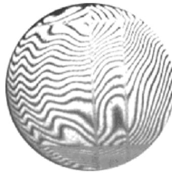
**Рис.3.** Интерферограмма обрабатываемой детали в технологическом блоке диаметром 230 мм. Ошибка формы 2.018 полосы (0,635 мкм) - от вершины до впадины, 0.45 полосы (0,142 мкм) rms.
