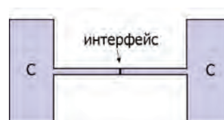
Рис. 1. Схема Джозефсоновского контакта с графеновой прослойкой. Интерфейс – структура изолятор – графен – изолятор. С – сверхпроводник
