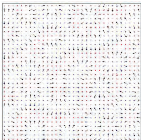
Рис. 2. Модельное распределение намагниченности пленки с перпендикулярной анизотропией и с учетом ВДМ. Размер участка 1 \times 1 \text{ мкм}^2
