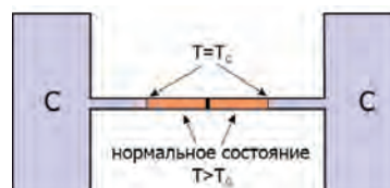
Рис. 2. Схема СИГИС структуры при больших значениях напряжения. T_c – критическая температура. С – сверхпроводник
