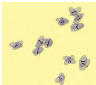
Рис. 1. Микроструктура системы магнитных анизотропных эллипсоидальных частиц (изображены только кластеры)
