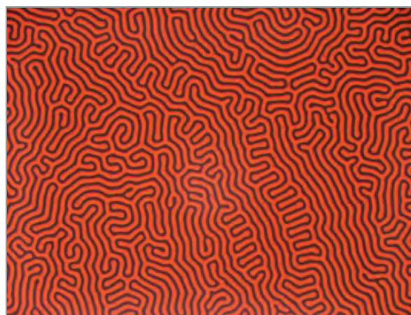
Рис. 1. Доменная структура пленки феррита-граната до диффузионного отжига
